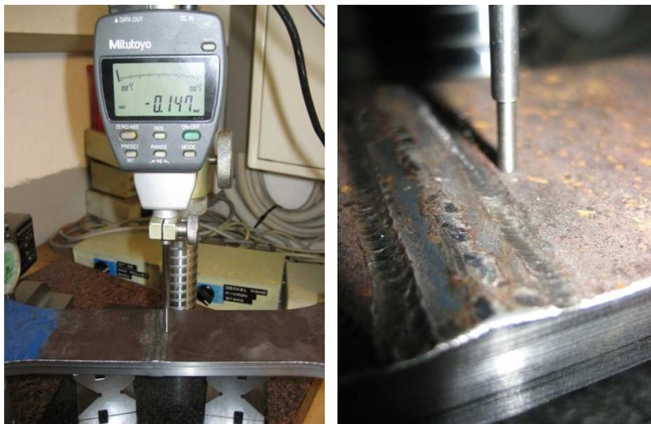
Abbildung 31. Vermessung der Eindrucktiefe an einer Stumpfnaht
