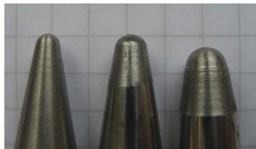
Abbildung 25. PIT-Behandlung des Versuchskörpers K-AW-690-09 mit unterschiedlichen Bolzenradien
