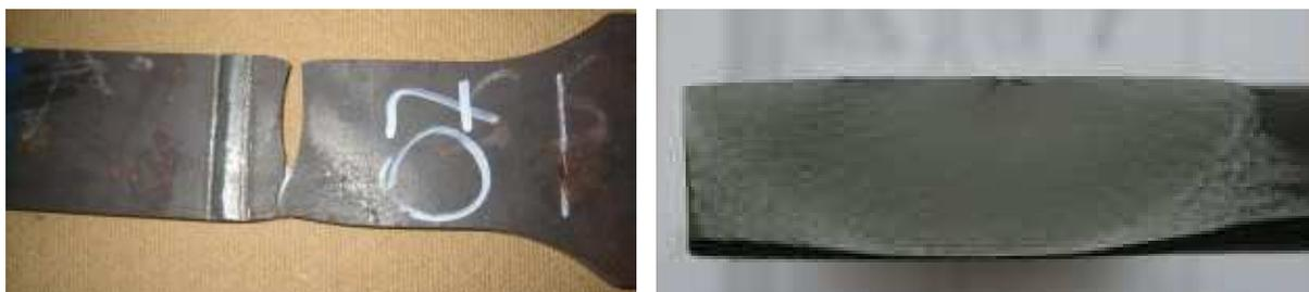
Abbildung 19. Bruch im Grundmaterial des Versuchskörpers S-PIT-355-07
