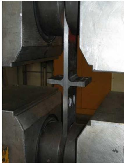
Abbildung 14. Versuchsaufbau und eingebauter Versuchskörper K-AW-690-01
