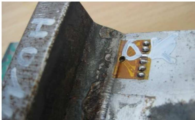
Abbildung 27. Lage der Eigenspannungsmessstellen, Bolzenradius  $r = 2,0 \text{ mm}$
