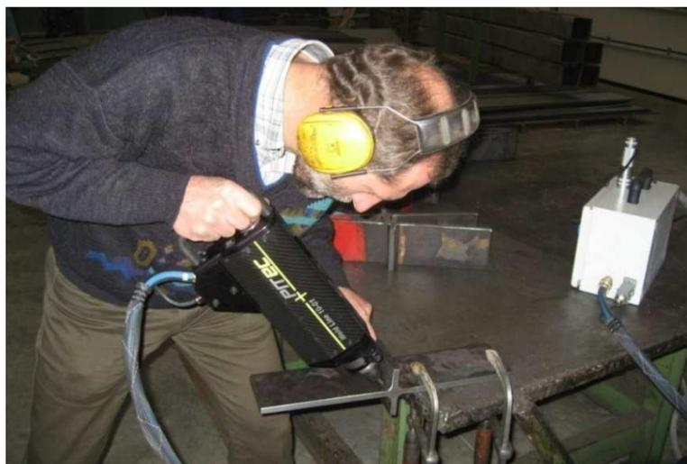
Abbildung 1. Schweißnahtnachbehandlung durch Anwendung des PIT-Verfahrens
